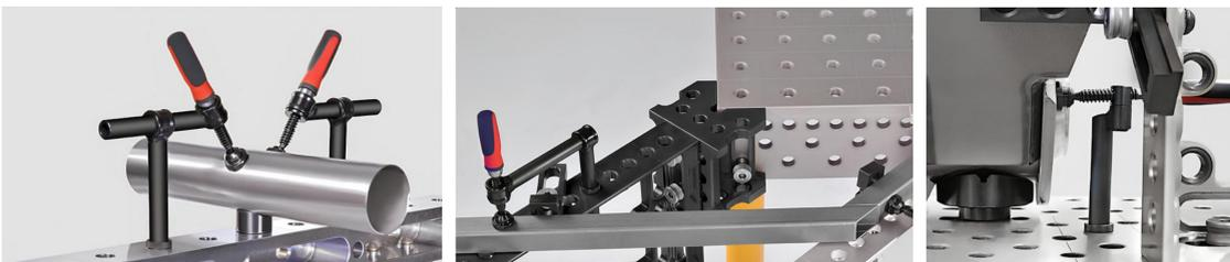
Струбцины устанавливаются и фиксируются в любом системном отверстии 16 системы. Обеспечивают быстрый, сильный и точный зажим различных сварочных элементов. Широкий диапазон регулировок, модульная и эргономичная конструкция обеспечивает высокую гибкость применения для решения любых задач
